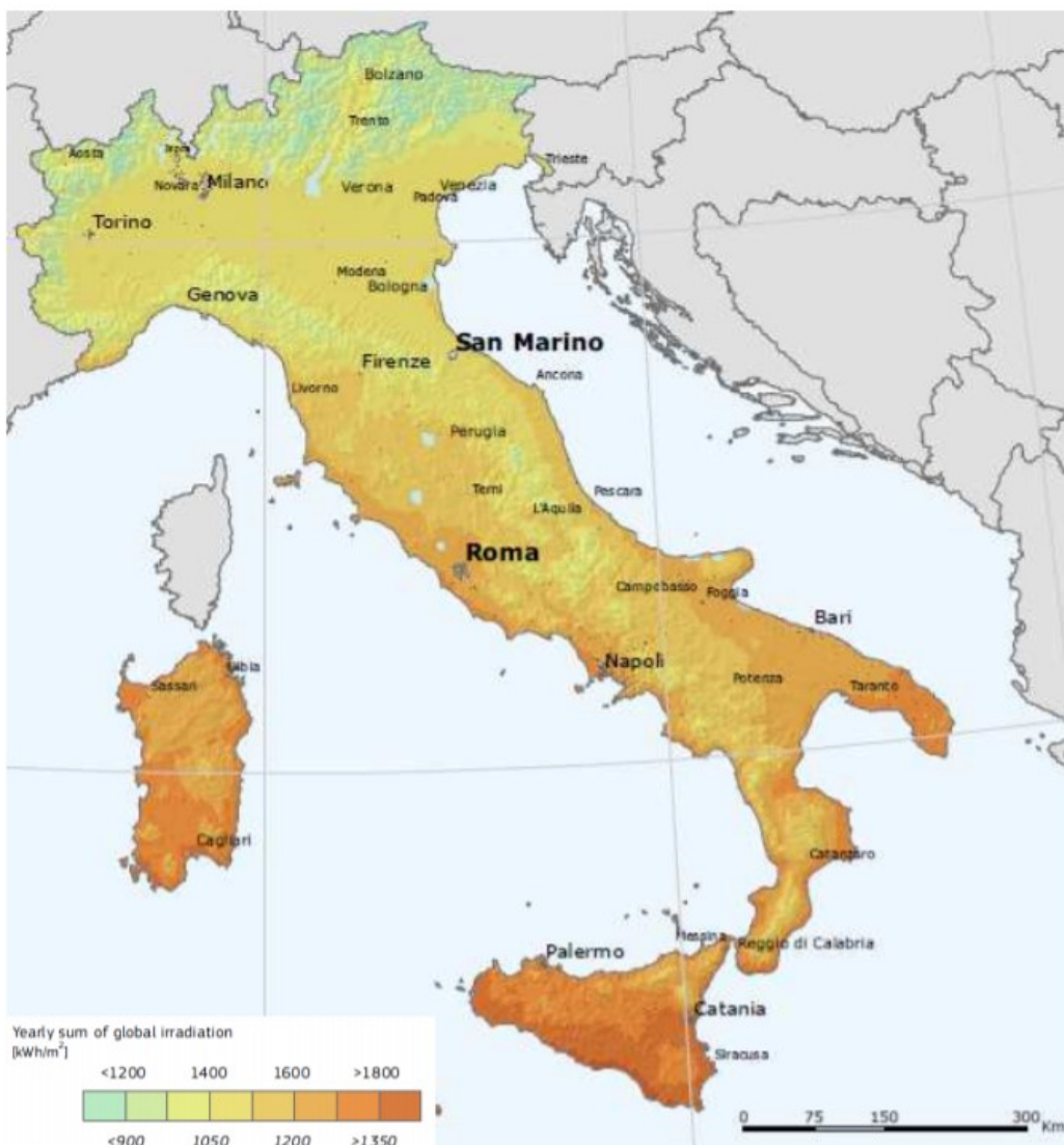
Figura 4: Radiazione globale e potenziale energia elettrica solare per inclinazione dei moduli fotovoltaici orizzontale [kW/hm 2 ] – Fonte JRC Europe
